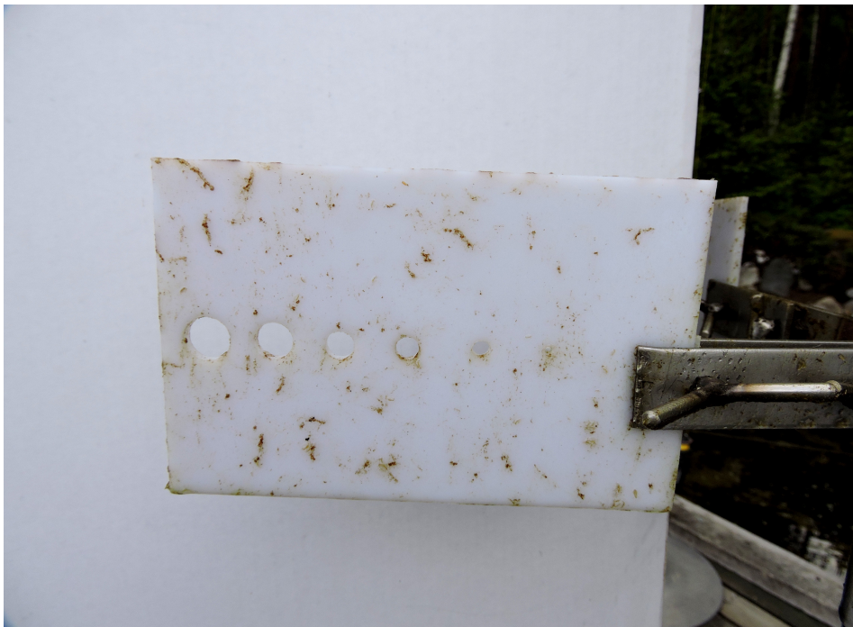
Tutkimuslevy, jossa on erikokoisia reikiä ja kiinnijäänyttä levää.
