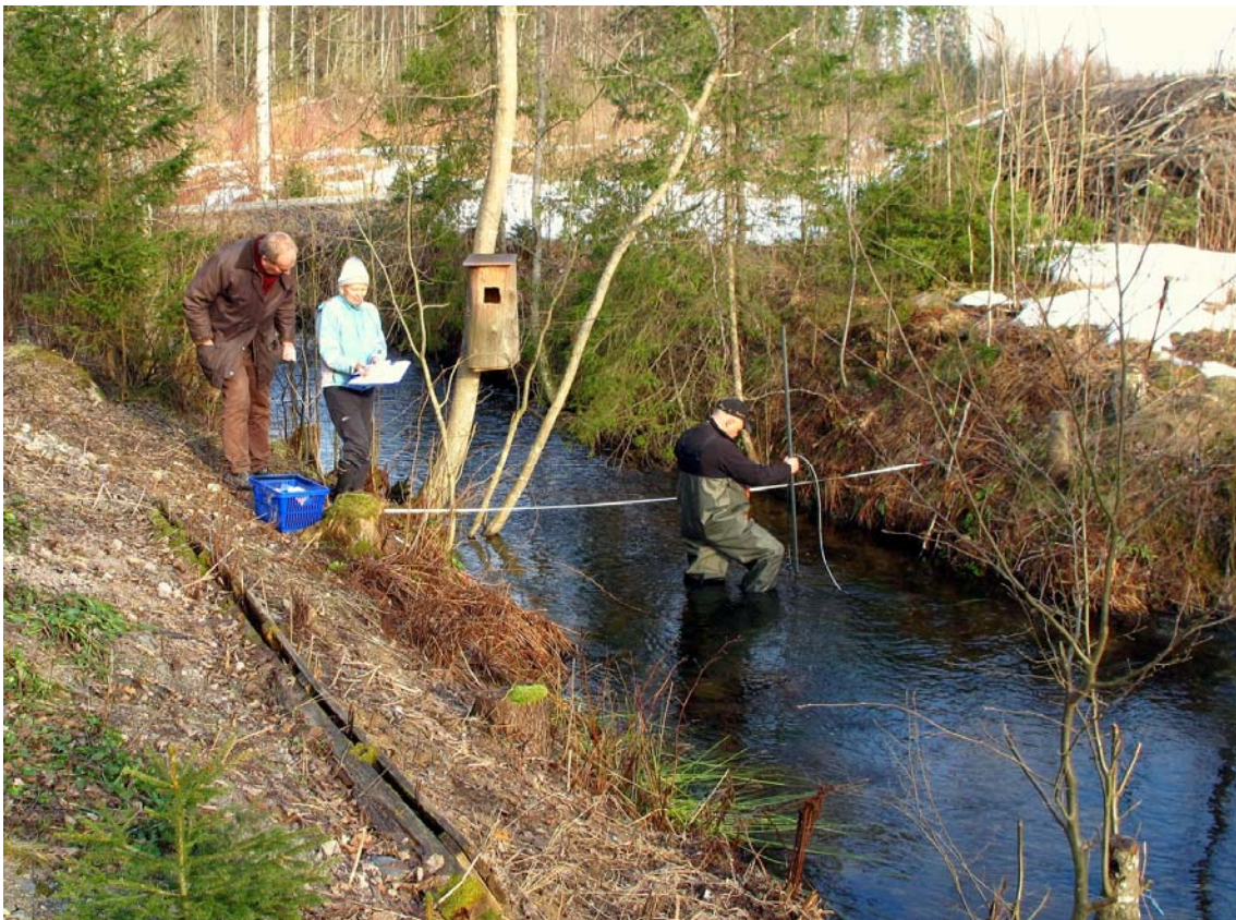
Virtaaman mittausta Kankaisten kylän näytepaikalla. Kuva Seppo Alkula 17.3.2015.
